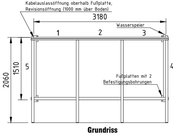
Auf Wunsch kann bei Bestellung kostenneutral eine Fußstützenverlängerung um 130 mm, für Überpflasterungshöhe bis 200 mm vorgenommen werden.
